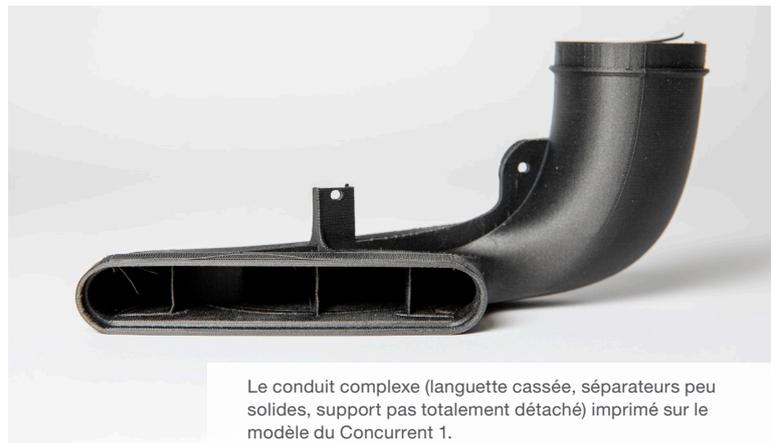
Le conduit complexe (langette cassée, séparateurs peu solides, support pas totalement détaché) imprimé sur le modèle du Concurrent 1.
