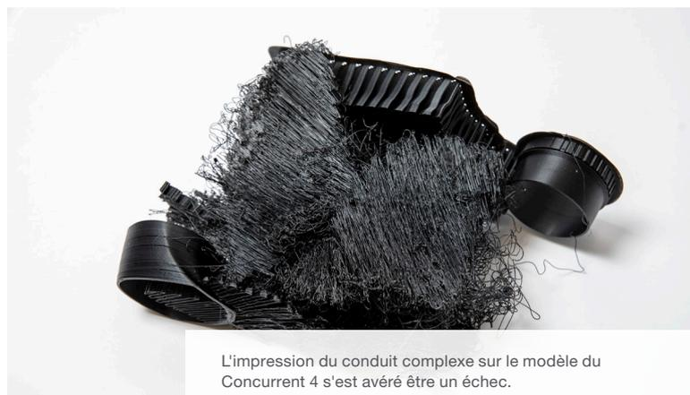
L'impression du conduit complexe sur le modèle du Concurrent 4 s'est avéré être un échec.
